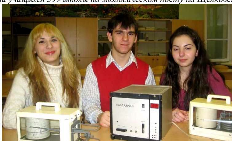
Рис. 2. Учащиеся школы № 399, определяющие концентрации угарного газа в пробах воздуха на приборе “Палладий 2”
